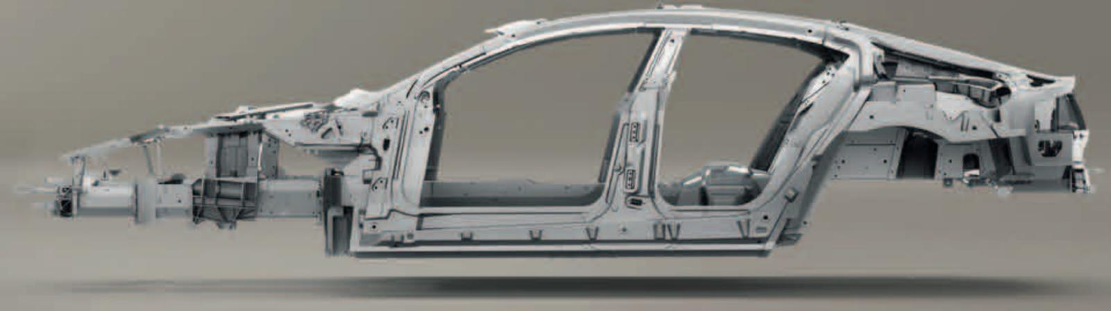
La Rapide S condivide la stessa avanzatissima costruzione in alluminio laminato e potenti organi di trasmissione con i nostri modelli GT e Super GT dell'ultimissima generazione. Costituisce così la piattaforma
